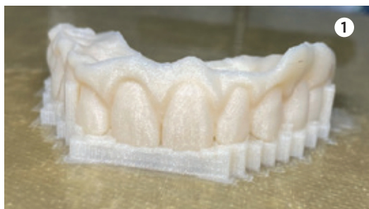
Fig. 1 Provvisorio stampato con Simplex 2SX
